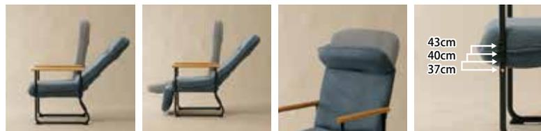
シートバックはレバー操作により7段階の調節可能    ヘッドレストが14段階の調節可能    組立時に座面高さを3段階に調整可能。
